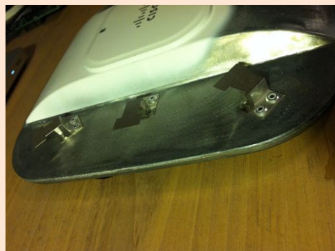
平面型倒F天線(Planar inverted-F antenna)(簡稱 PIFA)
