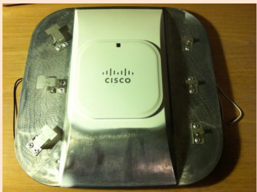
平面型倒F天線(Planar inverted-F antenna)(簡稱 PIFA)
