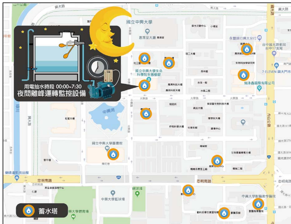
蓄水塔補水離峰用電管理
