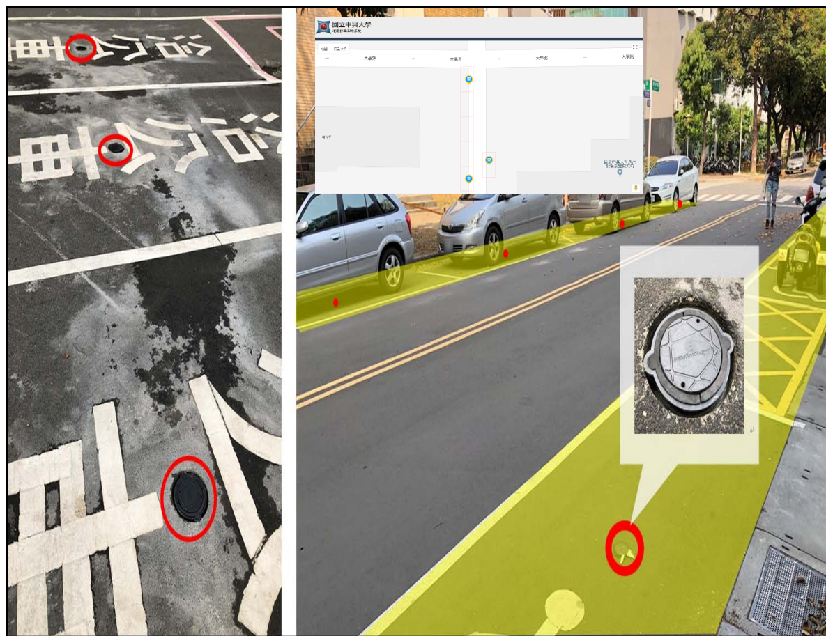
校園內小規模佈建進行地磁感測實驗的停車格
