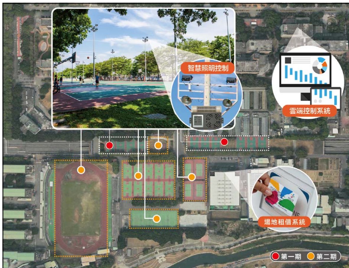
運動場域智慧化照明管理系統
